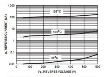
FIGURE 2. REVERSE CURRENT VS REVERSE VOLTAGE
